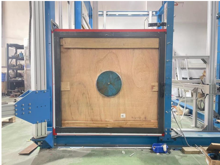
测试样窗 (已安装)
